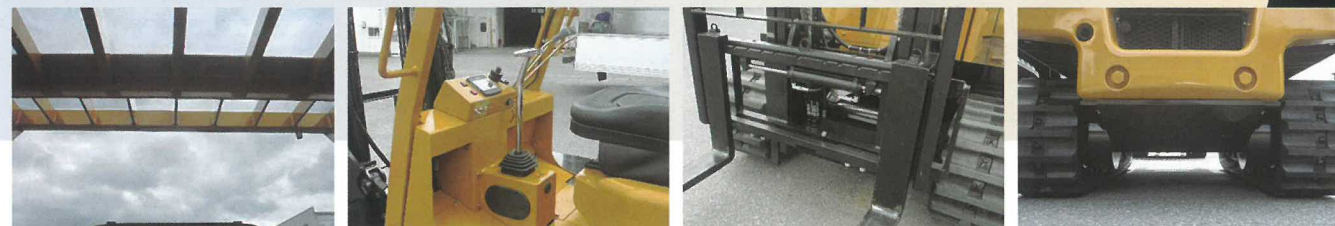
ポリカーボネート板 キャノピ天井の上方視界を確保。
